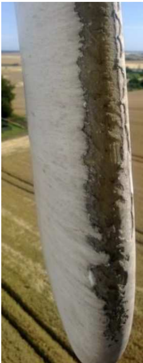
Figur 12 Et andet eksempel fra en ca. 17 år gammel mølle. Coatningen på forkanten er helt slidt af.
