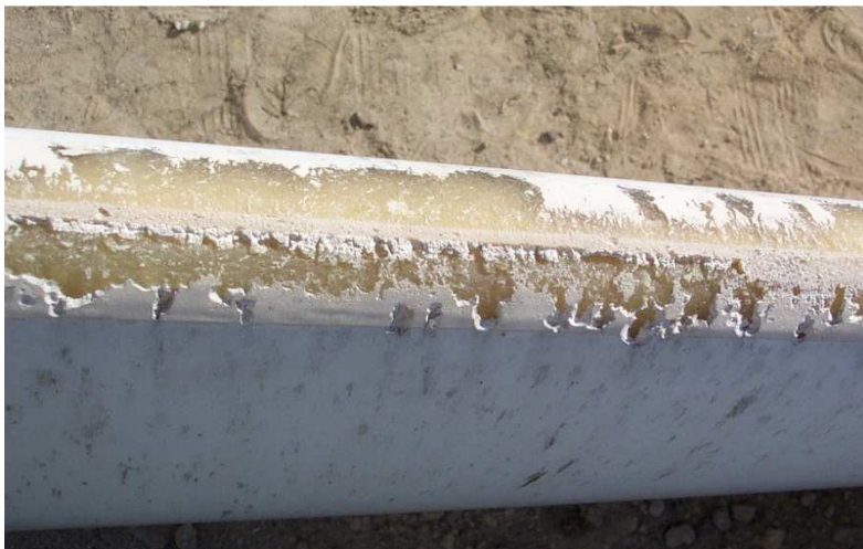
Figur 11 Eksempel på vinge overflade fra nedtaget DVT 400 kW mølle efter ca. 10 års drift. Ingen tvivl om at med den ru forkant, vil effektkurven forringes.
